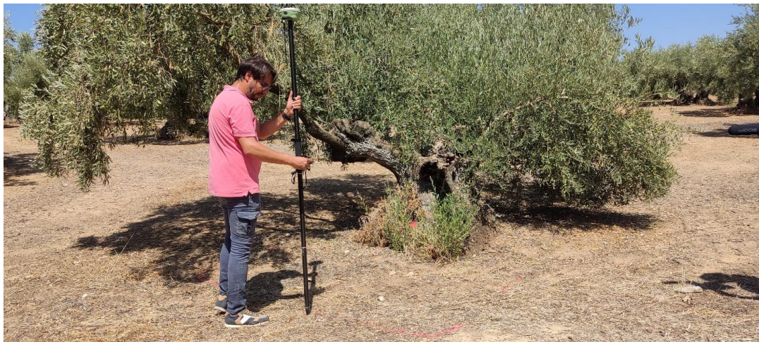
Georreferencia topográfica con GPS en posible anomalía en el subsuelo.
